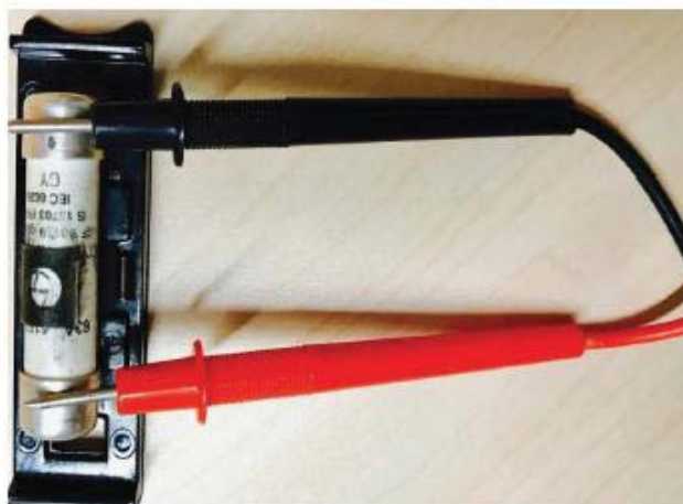
شکل ۱۴۱ - آزمون فیوز با استفاده از مولتی‌متر
