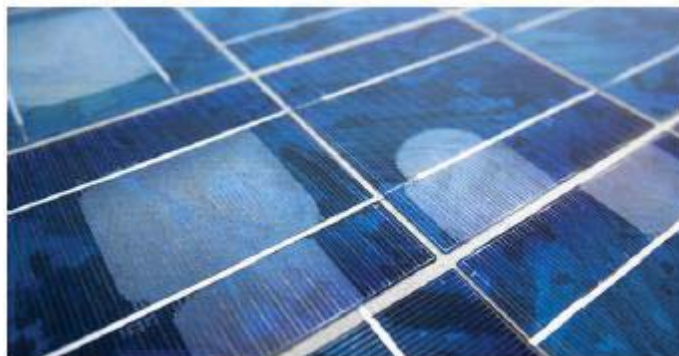
شکل ۳۴ - ترک‌های ریز و کوچک
