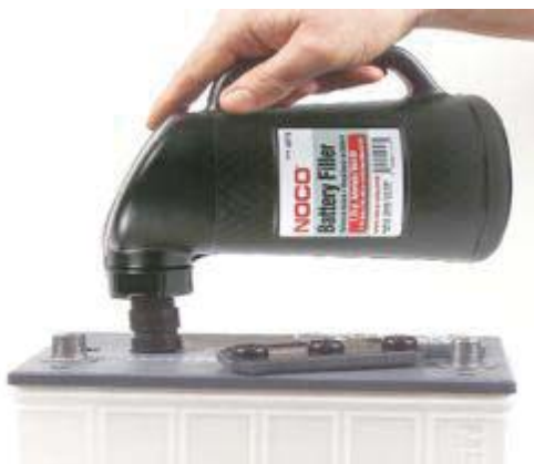
شکل ۱۲۶- پر کردن مجدد آب باتری
