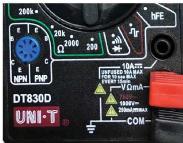
شکل ۱۳۹ - نحوه اتصال کابل‌های تحت آزمون به مولتی متر
