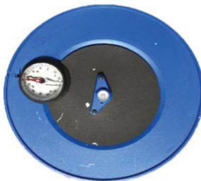
شکل ۵۴ - تنظیم‌کننده سطح مسیریاب خورشیدی
