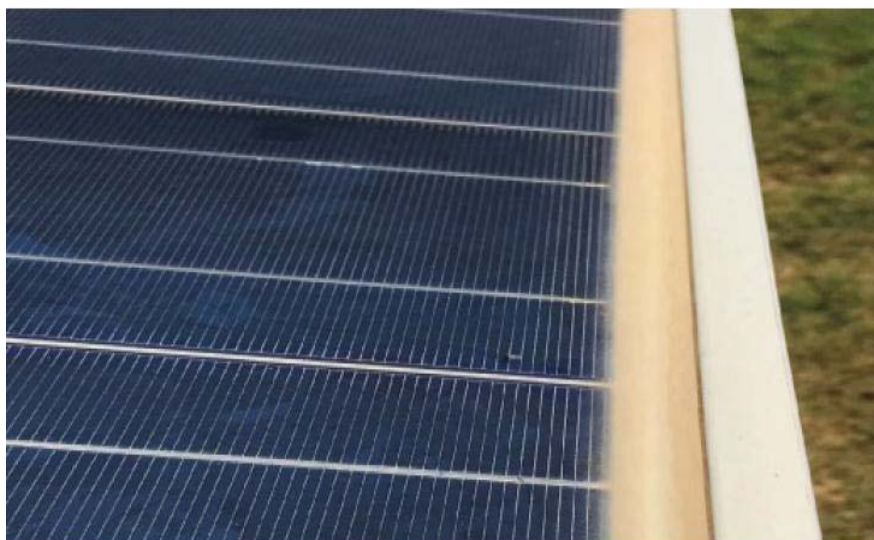
شکل ۴۱ - ایجاد لکه به دلیل درست تمیز نکردن و کیفیت آب
